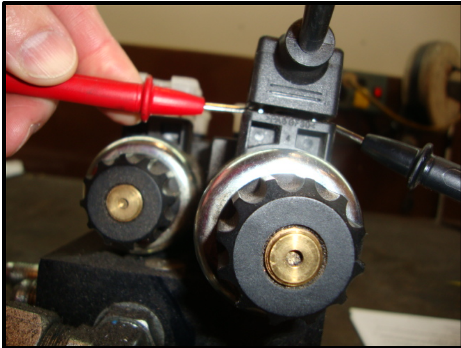
Fig. 8.4 Checking Din Plug Voltage
